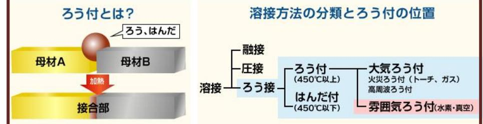
金属などを接合する「溶接技術」には様々な接合方法があります。ガス溶接やレーザー溶接などの「融接」、拡散接合などの「圧接」、そして「ろう接」があります。「ろう接」には「ろう付」と「はんだ付」があります。溶加材の融点が450℃以下が「はんだ付」、それ以上が「ろう付」と定義されています。「ろう付(はんだ付)技術」は特長のある接合技術で幅広い分野で使用されています。
