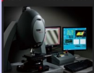
非接触三次元表面形状測定機
